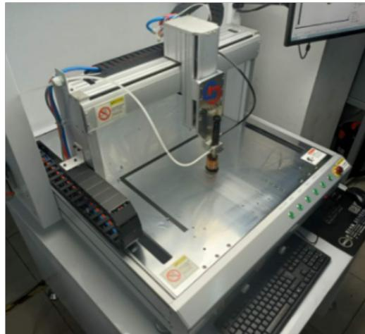
随着封装设备发展，点胶技术也在慢慢的在提升，从开始粗劣的手动点胶到现在视觉喷胶工艺的诞生，点胶有着很大的进步，从开始只为了降低人工成本，到现在全自动化生产模式，点胶技术优势越来越好，能够应用的行业也越发的广，饰品点胶就是CCD视觉点胶机应用的某一个行业，视觉喷胶工艺能够快速描绘一个优美的图案，让饰品更加漂亮。饰品点胶是为了让图案和色彩更加好看CCD视觉点胶机能够使用各种不同颜色的漆胶，让其快速喷粘在饰品上，让其形成各种不样的图案，能够让人看着更加心动，饰品属于国内的一个快销品，但是图案和样式不够鲜明，却不会有多少人进行购买，饰品点胶就能够让其附上更多的色彩，选择购买的人数就更加多。使用CCD视觉点胶机能够画各种不一样的图形，上色也能够同时上几种颜色，所以现在国内饰品生产基本都是采用视觉点胶机进行生产。佛山青蛙夹点胶点钻一体机怎么操作点胶点钻一体机使加工速度得到一定的提高，用少量人力投入就能实现大批量的生产，粘贴牢固可靠。
